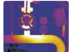
Thermografische Aufnahme einer defekten Absperrvorrichtung
