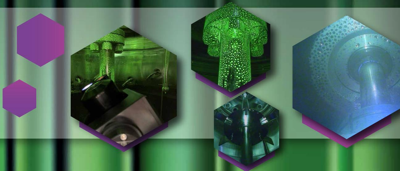
Prüfen Sie die Reinheit Ihrer Behälter mit der SNK Ultra 365! Das Innere des Behälters wird dabei mit einem fluoreszierenden Kontrastmittel (z. B. Riboflavin) benetzt. Durch den normgerechten 365 nm UV-Emitter der SNK Ultra 365 werden kontaminierte Stellen im Behälter sichtbar. Nach jeder Reinigung wird dieser Prüfprozess wiederholt, bis auch die SNK Ultra 365 keine Rückstände mehr erkennt.
