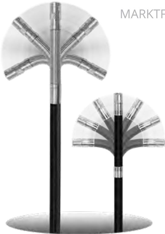
Das pneumatische Abwinkelungssystem X-WAY erlaubt volle Abwinkelung auf allen 4 Achsen (oben/unten/links/rechts) für alle VUMAN® X-WAY-Sonden. Die Kontrolle erfolgt per Joystick an der VUSCREEN-Bedieneinheit und wird von einem integrierten, computergesteuerten Mikrokompressor angetrieben, wodurch externe Druckflaschen oder Luftdruckquellen entfallen.
