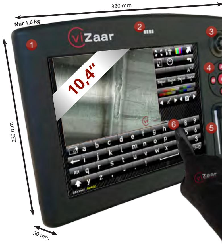
Der VUSCREEN vereint PPE-Kompatibilität, z. B. Bedienung mit Schutzhandschuhen, mit einer intuitiven Benutzeroberfläche und erweiterten Software-Features. Mittels Joystick bietet er perfekte Kamerakontrolle in jeder Situation und zeichnet ein kristallklares Bild auf das 10,4" große Display.
