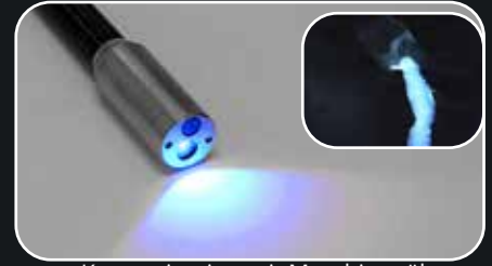
Kontamination mit Maschinenöl
