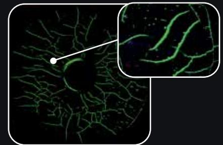
Werkstück zur Kalibrierung bei Magnetpulver-Rissprüfung. Referenz Standardtyp 1 (MTU-No.3) gemäß EN 9934-2. Screenshot UVIN 13.4
