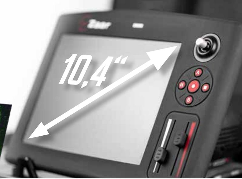
Mit 10,4" ist der VUSCREEN der größte Touchscreen auf dem Markt für Inspektionssysteme. Zu seiner PPE-Kompatibilität, dem stoßfesten Rahmen, der präzisen Joystick-Steuerung und den zahlreichen Bildbearbeitungsmöglichkeiten kommen nun ein vergrößerter Farbraum, eine erhöhte Leuchtdichte von 850 cd/m<sup>2</sup> und eine größere Auflösung von 1.440 x 1.080 px hinzu. Profitieren Sie von noch helleren, klareren und kontrastreicherer Inspektionsbildern in besonders natürlicher Farbdarstellung.
