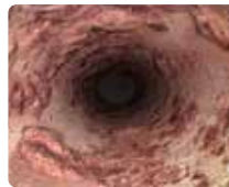
Kalkablagerungen an der Rohrinnenwand
