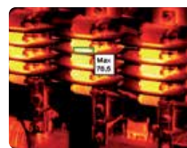
Trennschalter bei 75°C
