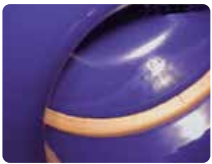
Defekte Dichtung in Glas-schichttank
