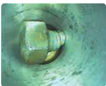
Schraube in einer Rohrleitung
