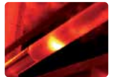
Durchnässte Begleitheizungs- dämmung
