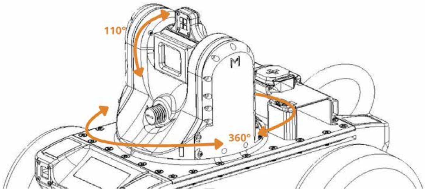
Ein Klick genügt: Die Steuerung wird umgeschaltet und der Drehkopf rotiert automatisch um 180°. Der Roview 3 kann nun mühelos in entgegengesetzter Richtung weiter fahren und die Telemetrie bleibt durchgehend konsistent.
